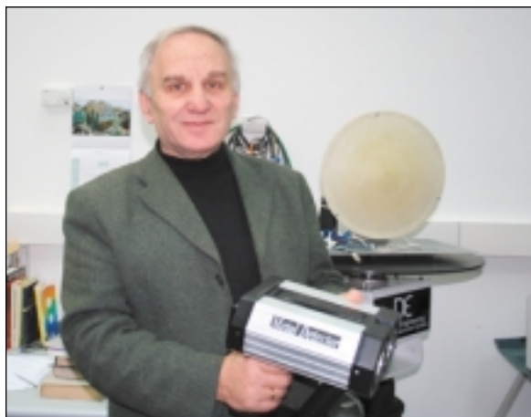
Le professeur Boris Kapilevich dirige le département d'ingénierie électrique et électronique. Le voici avec son détecteur de métaux à distance qui permet de découvrir des armes ou des explosifs cachés sous des habits jusqu'à une distance de 3m.
