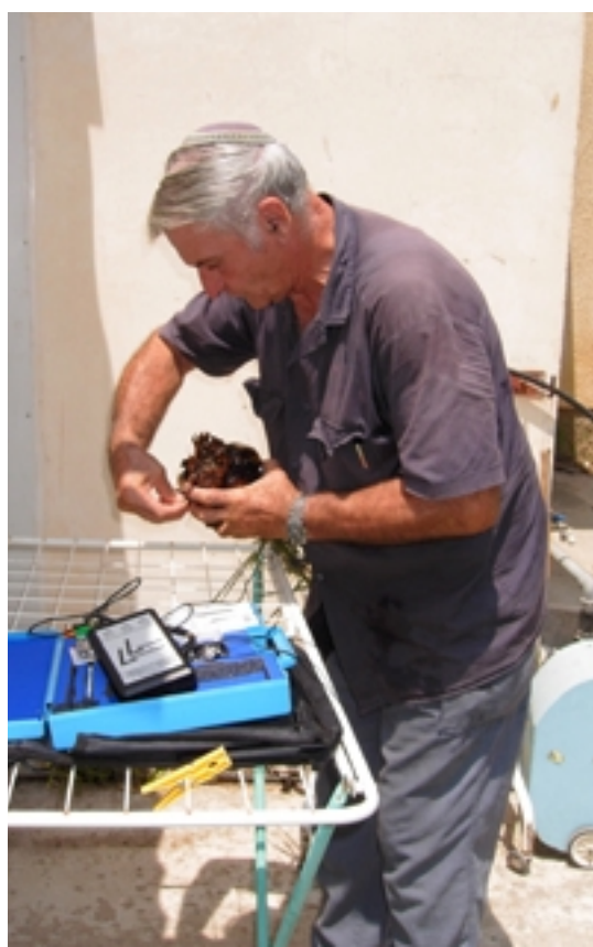
Yaacov est particulièrement inventif. Le voici en train d'écouter des larves qu'il a implantées dans un morceau de palmier. Il enregistre leurs bruits puis les étudie afin de pouvoir les identifier dans les plantations.
