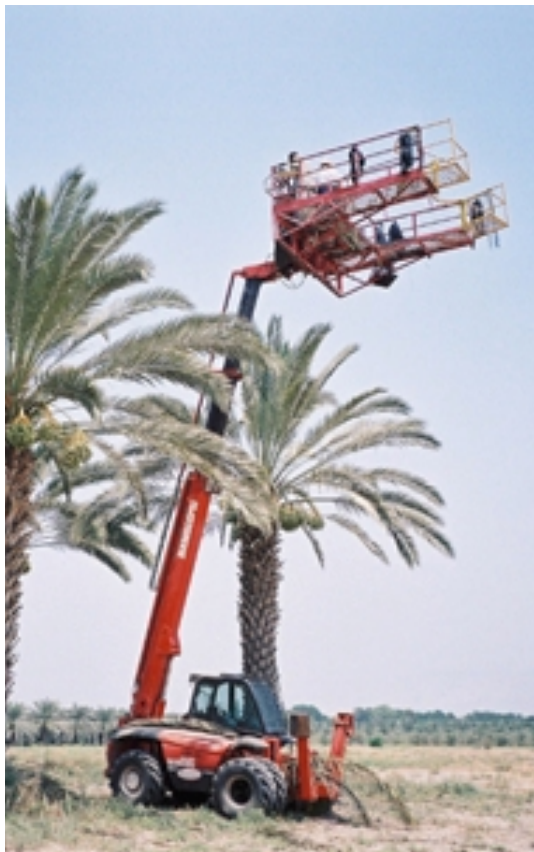
Der Kibbuz entwickelt eine grosse Zahl neuer Technologien zur Verbesserung der Dattelproduktion, wie z.B. die hydraulischen Leitern, die bis zu einer Höhe von 25 m ausgefahren werden können.
